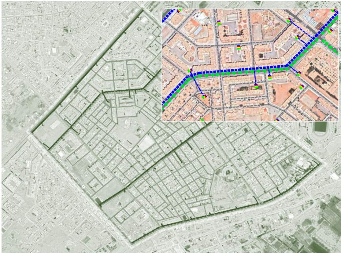
Figure 13 disposition des bornes de déchets Source : auteur
