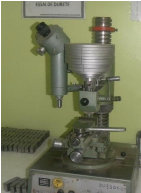
Figure IV.7: Microduromètre Vickers. Figure IV.8 : Mode opératoire de l’essai de microdureté [22]
