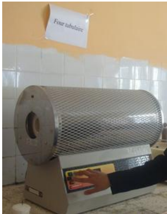
Figure IV.4 : Four de traitement thermique maxi 1000°C
