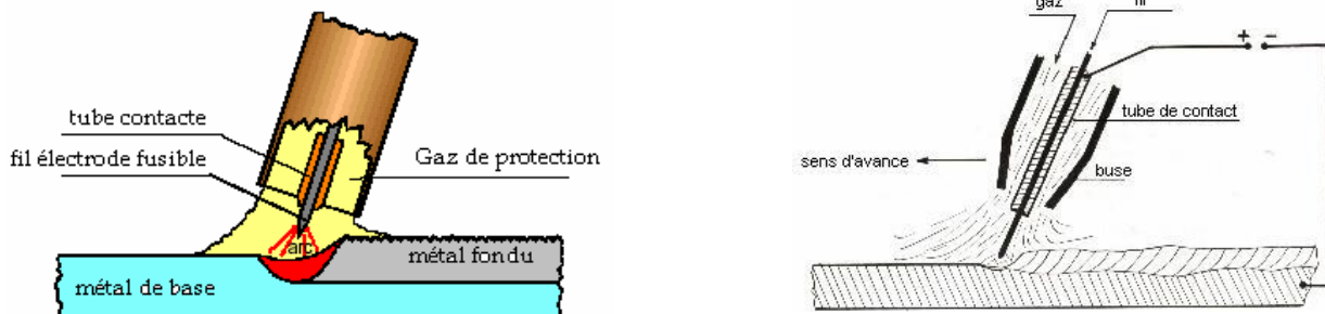
Figure I.7. Schéma de principe du soudage MIG [5]
