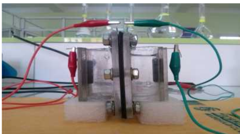
Figure IV.2 : Photographie de la cellule à quatre électrodes et deux compartiments.
