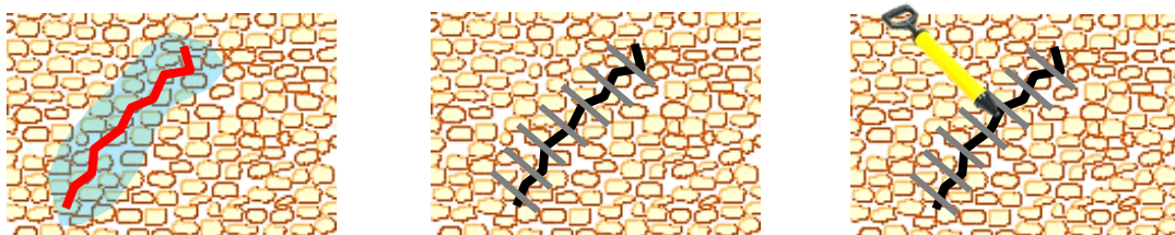
Fig.III. 26 : Schéma de traitement des fissures profondes
