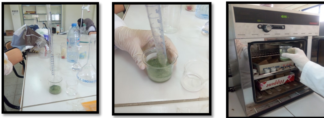
Figure 26 : Acidification de la spiruline par l'acide sulfurique et étuvage
