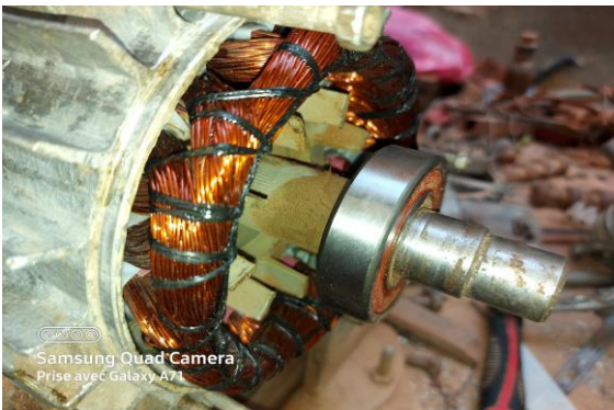
Figure (II.14) Vernissage de bobinage
