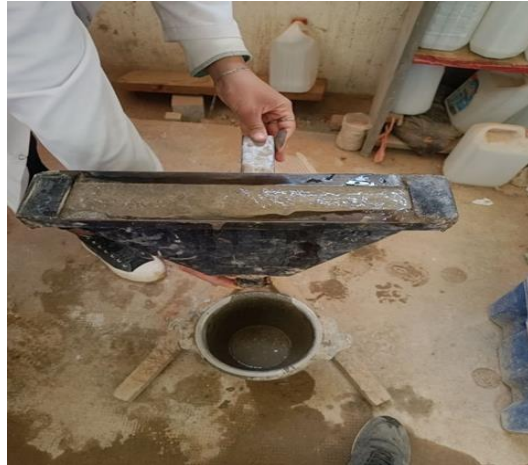
Figure 2.11 : Essai d'écoulement au mini-entonnoir en V : comptage du temps d'écoulement.
