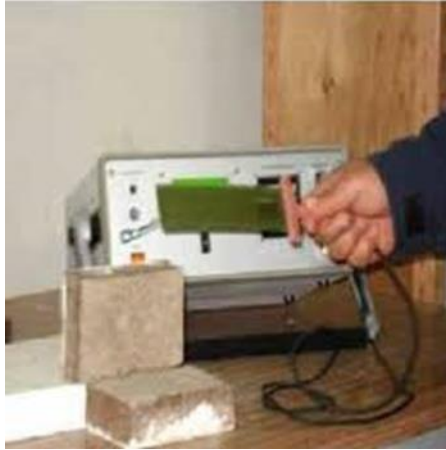
Fig1.8 Essai au CT-mètre du CNERIB
