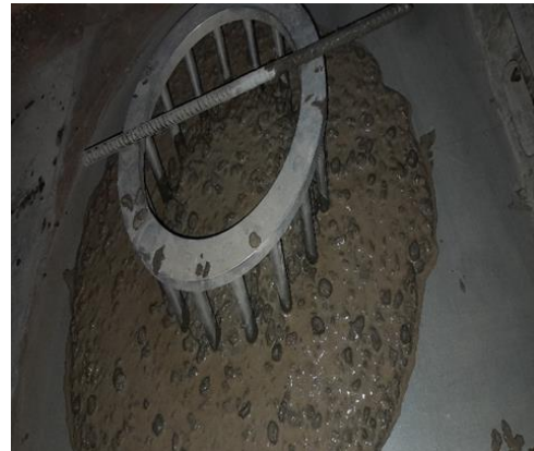
Figure 2.13 : Essai d'étalement à la couronne (J-Ring), (a) : Exécution de l'essai, (b) : mesure de l'étalement
