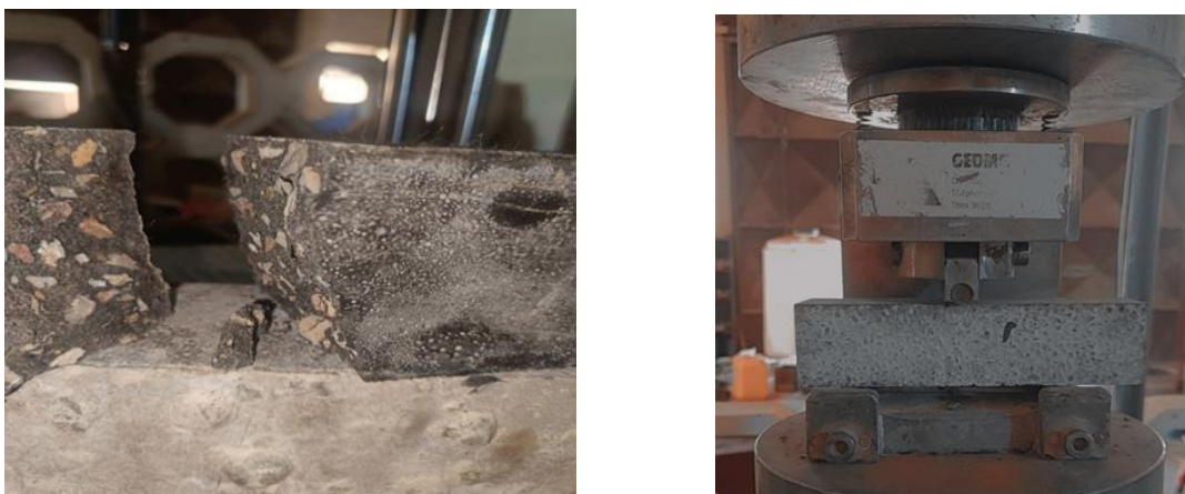
Figure 2.18 : Détermination de la résistance à la traction par flexion trois point.
