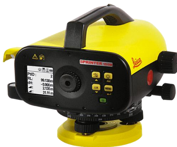
FigureIII.7: niveaux numériques de leica ( sprinter 150 )
