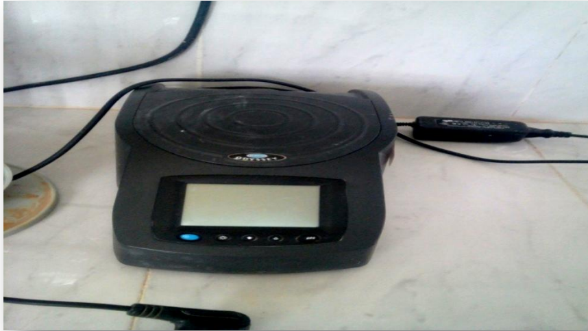
Figure 12: Spectrophotomètre UV visible utilisé pour la détermination du taux des nitrates
