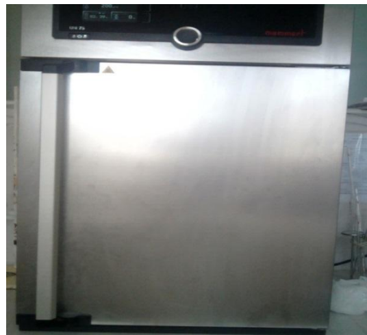
Figure 08 : Étuve pour le séchage
