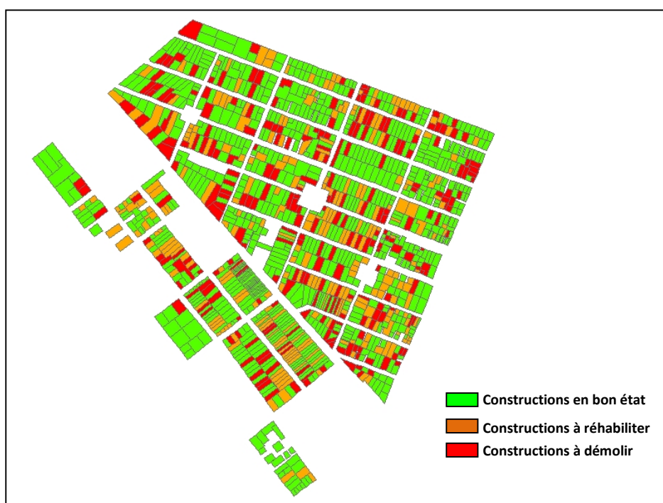
Figure II.12. Etat clinique du bâti du quartier El-Hamri d'Oran
