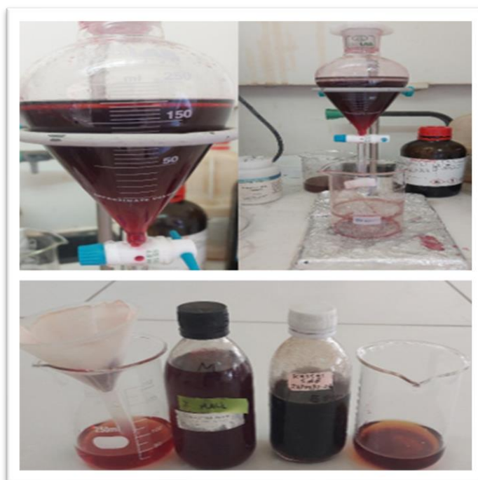
Figure13. Les étapes de l'extraction liquide/liquide
