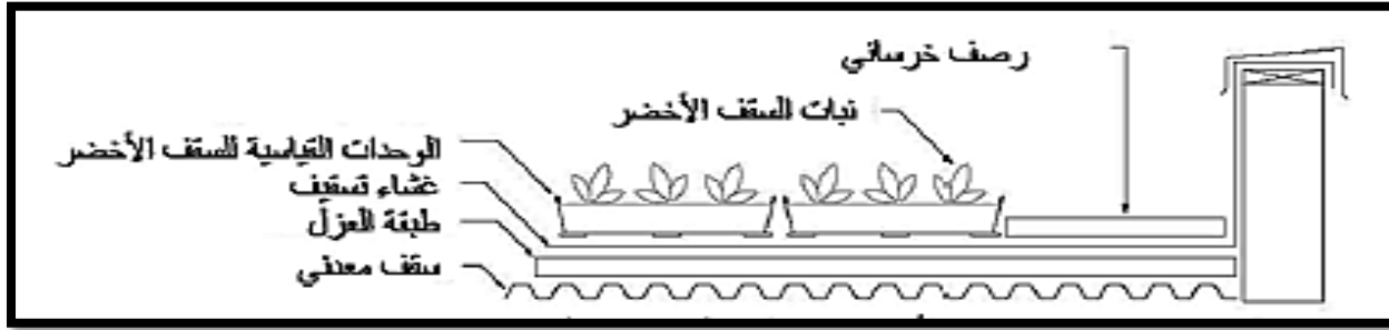
شكل 4-16 - قطاع عرضي نموذجي يوضح تصميم السقف الأخضر في حالة نظام الوحدات المصدر: معدل من طرف الطلبة, Kelly
