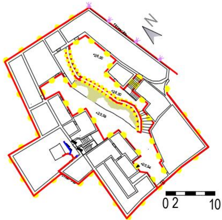
Figure 47: plan d'installation d'éclairage extérieur source : auteure
