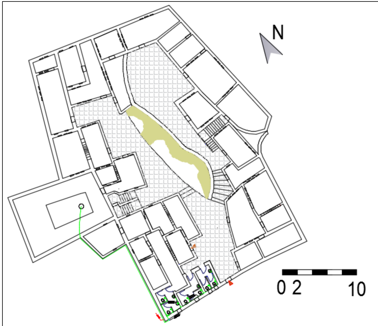
Figure 44: plan d'installation du réseau d'AEP source : auteure
