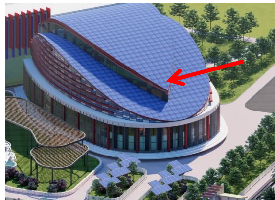
Figure 245: mur solaire photovoltaïque Source : auteur
