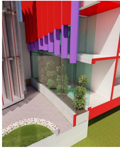
Figure 243: serre bioclimatique Source : auteur
