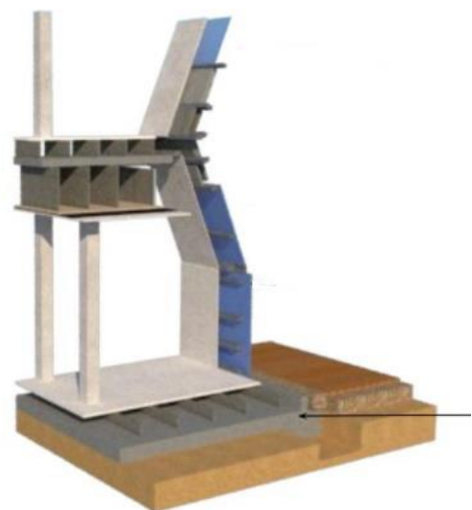
Figure 76 : structure en béton armé Source : http://townshendla.com/
