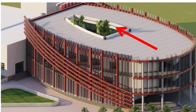
Figure 248: ventilation par patio Source : auteur
