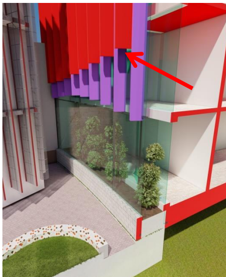
Figure 250: brise soleil Source : auteur
