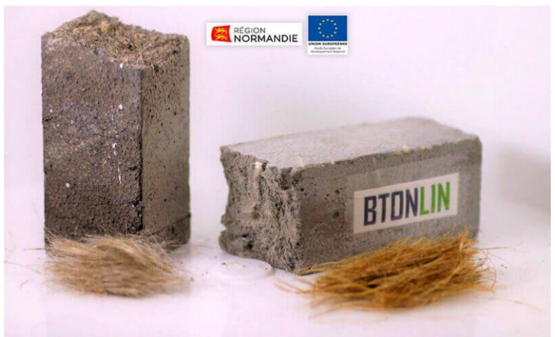
Figure 256: béton recyclable (bio-sourcées)
