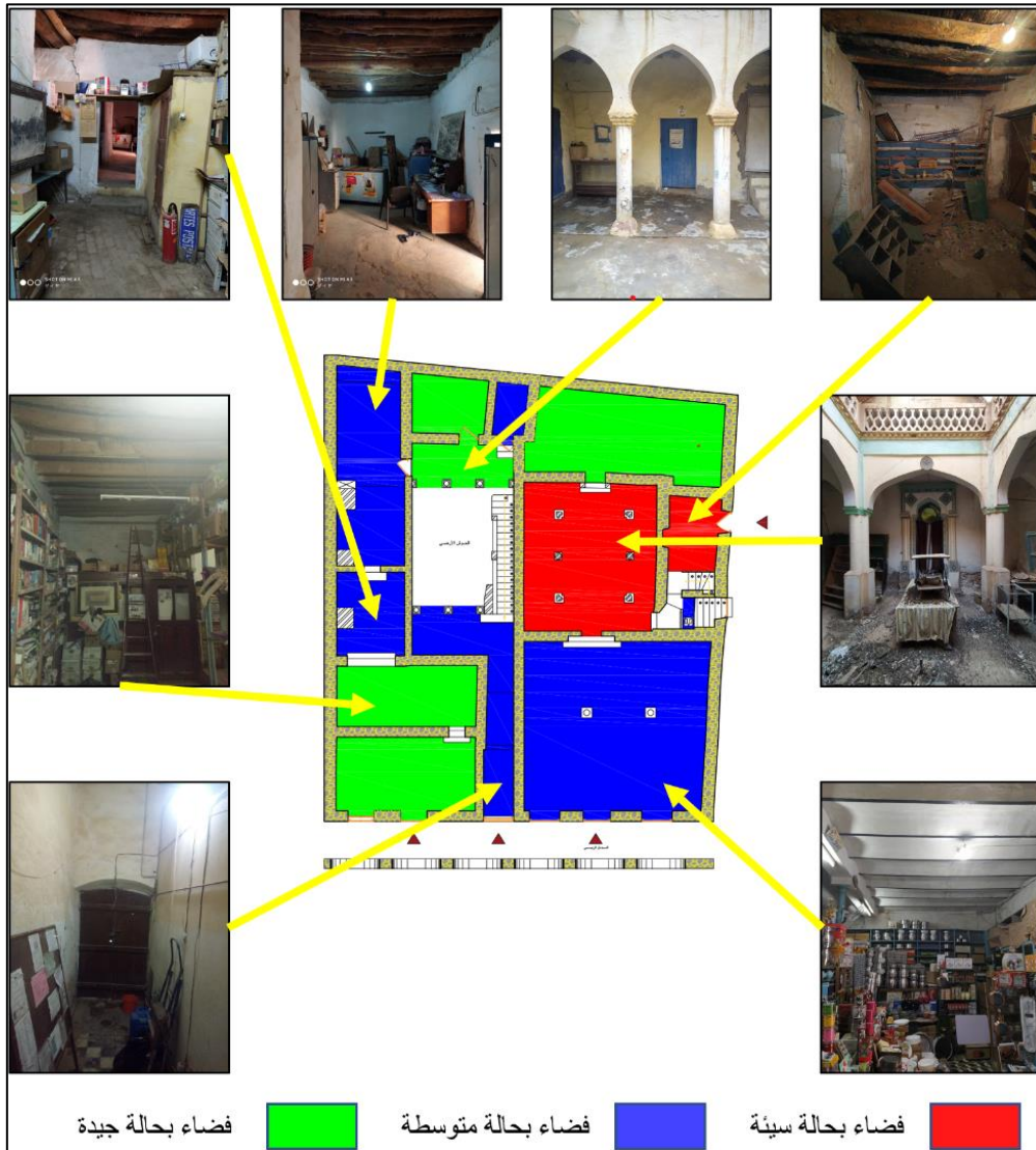
شكل 42 : الحالة التقنية ( حالة الحفظ الراهنة ) للطابق الأرضي
