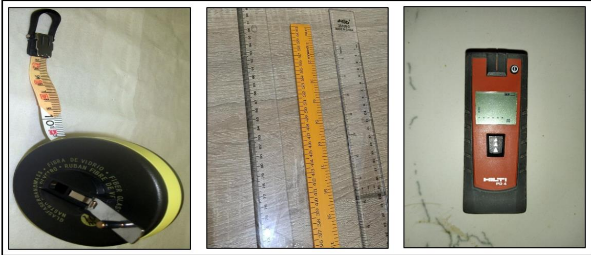
شكل 21 : الأدوات المستعملة في الرفع المعماري جهاز قياس ليزري ، مسطرة قياس 30 سم ، ديكامتر 20 م المصدر : من إعداد الطالب
