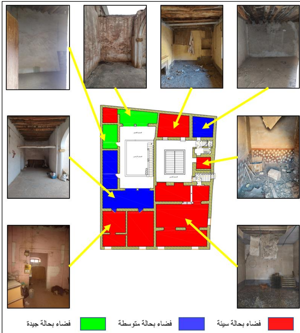
شكل 43 : الحالة التقنية ( حالة الحفظ الراهنة ) للطابق الأول
