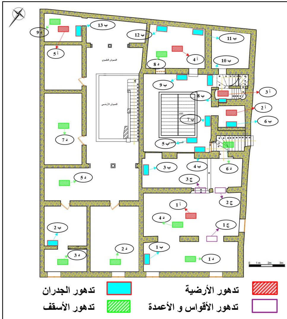
شكل 45 : يوضح مختلف مظاهر التلف لمخطط الطابق الأول العلوي
