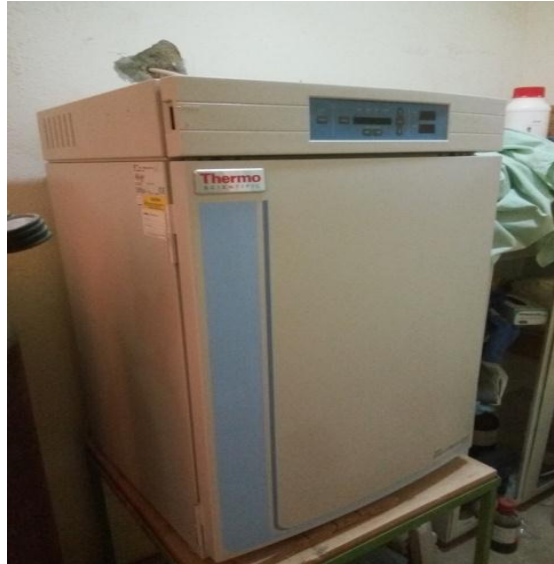
Figure II.11 : Enceinte de carbonation
