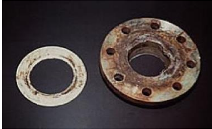
Fig III. 7: Corrosion caverneuse d'un acier allié sous un joint [20].
