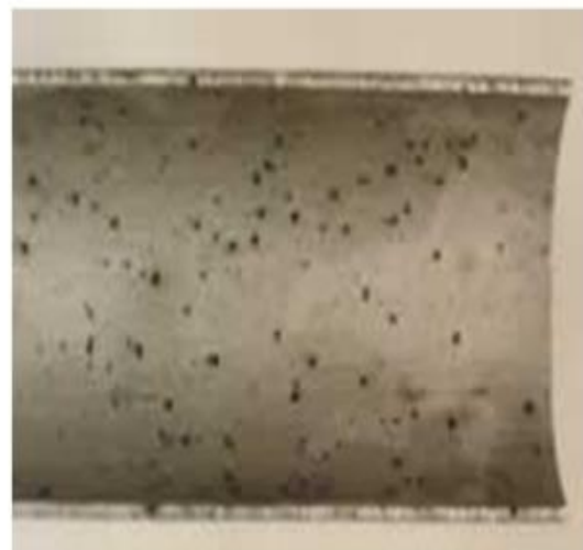
Fig III. 3: Corrosion par piquêres. [15]
