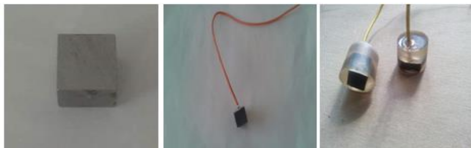
Fig IV. 9: préparation des électrodes de travail.
