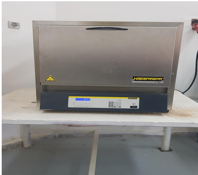
Fig IV. 1: Four électrique à moufles utilisé pour les traitements thermiques.
