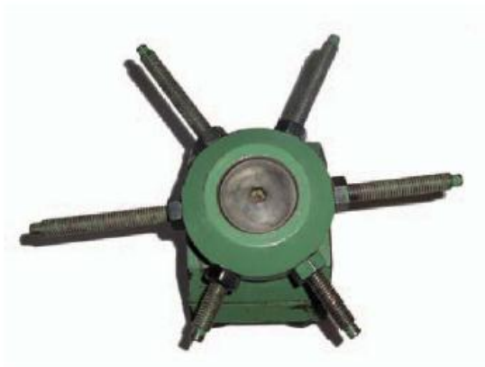
Figure 8.2 : Butée de trainard réglable d'un tour parallèle [1].
