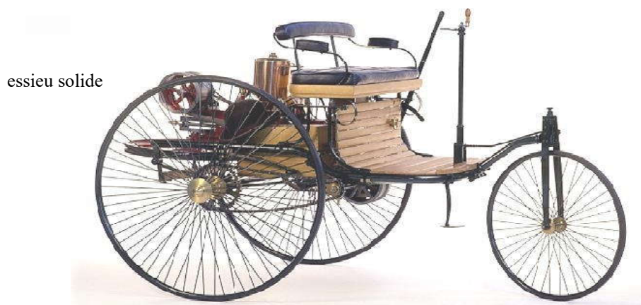
Figure (I.3) Première automobile équipée d'un Moteur à combustion interne, construite par Karl Benz en 1886 [7]
