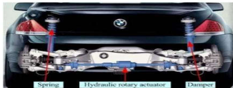
Figure (I.13) Profil des suspensions actives Hydrauliques commerciales à faible bande passante utilisées dans la BMW 545[25]
