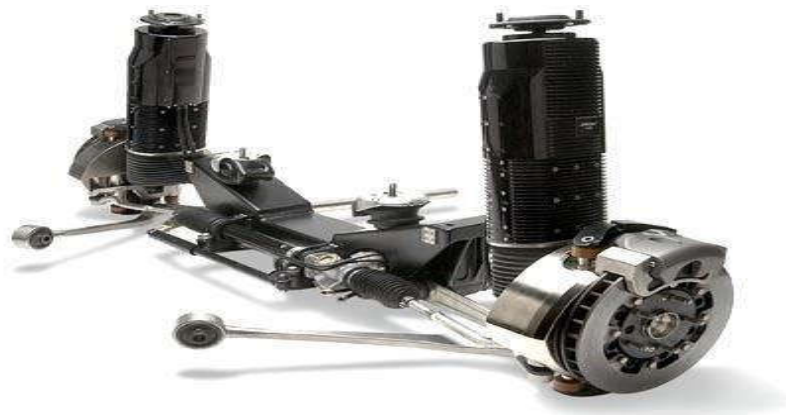
Figure (I.4) Module avant de la suspension BOSE [11]
