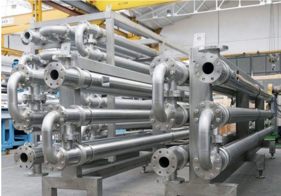
Figure I-8 : Echangeur de chaleur double tube
