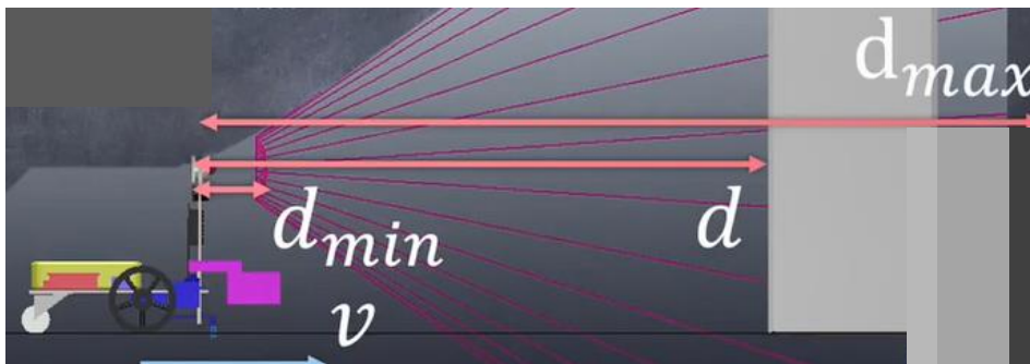
Figure I.13 Détection d'un obstacle avec le capteur ultrason se trouvant à l'avant du robot
