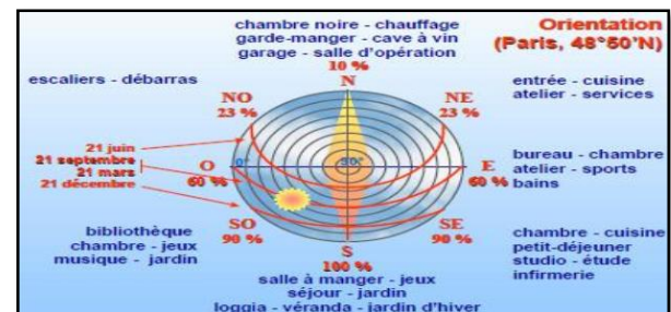
Figure 18 : L'orientation de l'édifice par rapport aux vents et au Soleil Source : Traité d'architecture et d'urbanisme bioclimatiques
