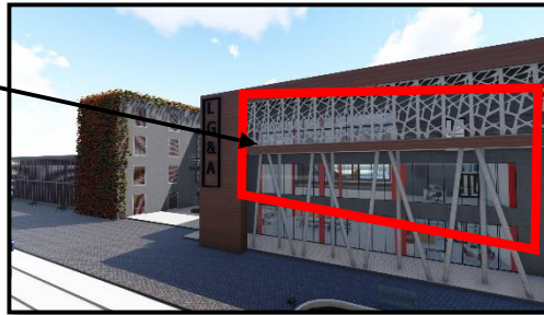
Figure 179: pilotis rond incliné Source : auteur.
