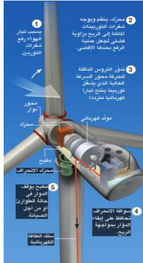
الصورة رقم (123) - توضح مكونات التوربينة المصدر : مجلة العلوم
