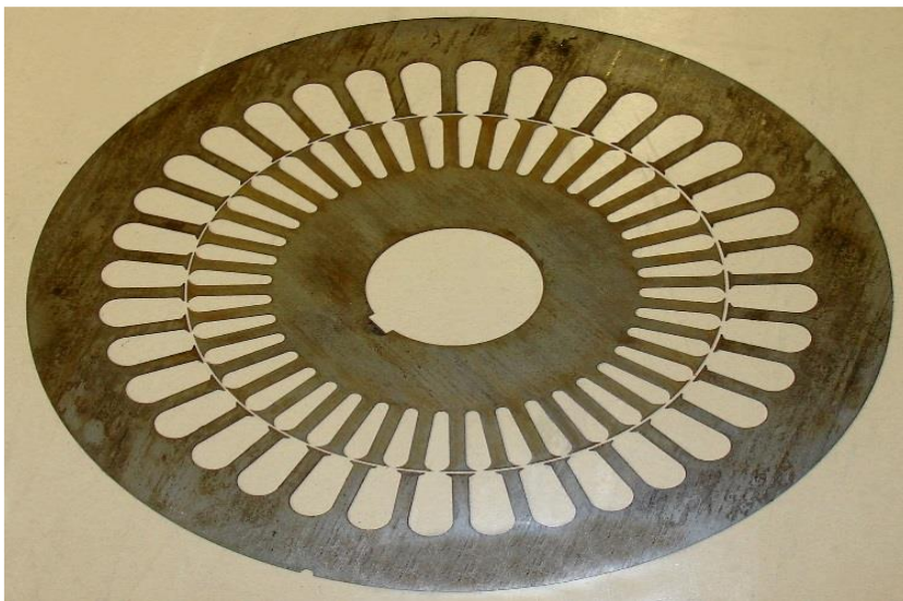
Fig. I.8 : Tôle utilisé pour la réalisation des cages à double encoche
