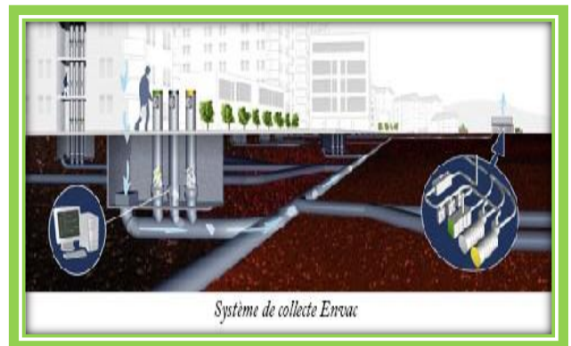
Figure 113: réseau de collecte des déchets sous terrain
