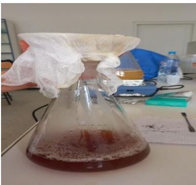
Figure 07 : Photographie originale montrant la filtration du sirop de dattes.
