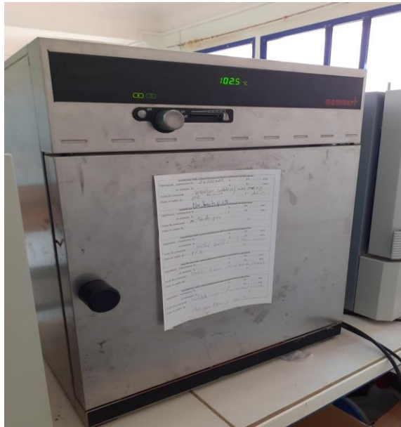
Figure 07 : séchage a l'étuve photo originale
