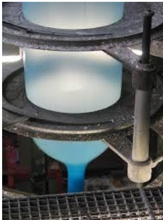
Fig.1 : Ligne de production de film en PEBD; sortie du plastique de la filière suivi du gonflage de la bulle.
