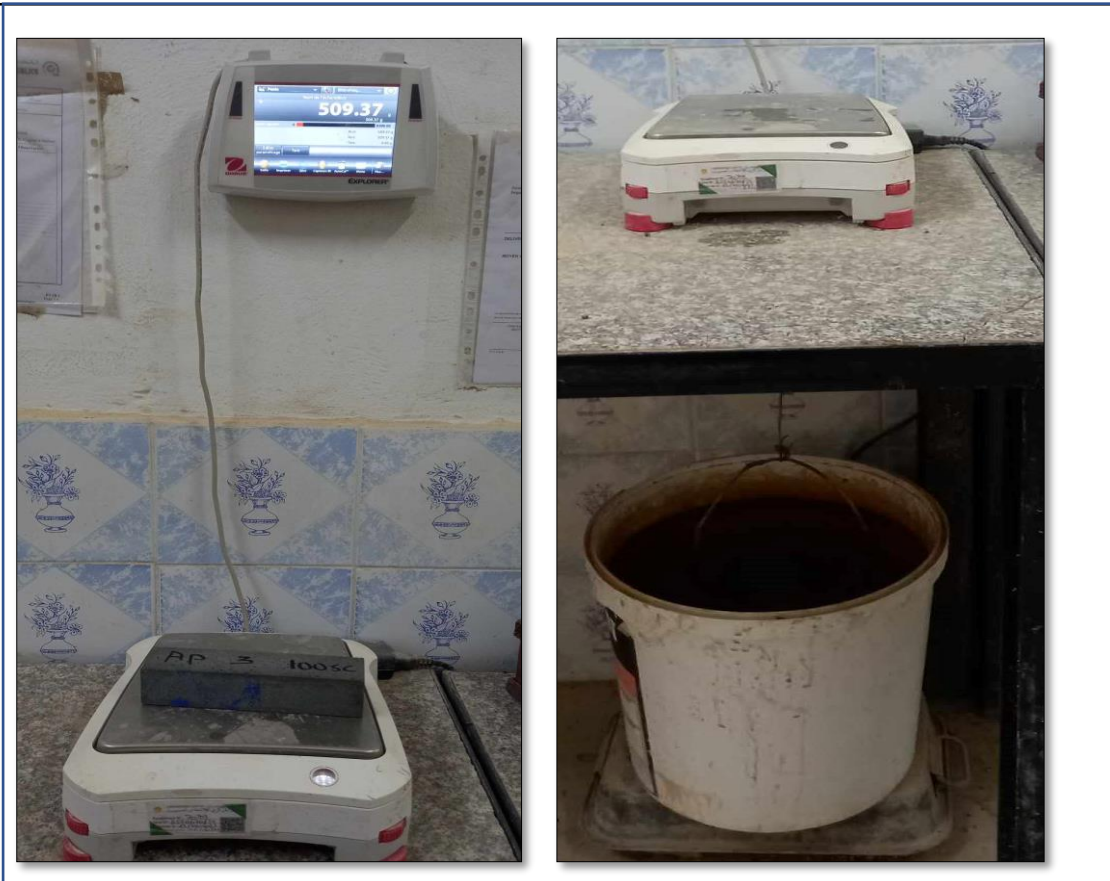
Figure II.18. Essai de Porosité accessible à l'eau et pesée hydrostatique dans laboratoire LCTP DJELFA.
