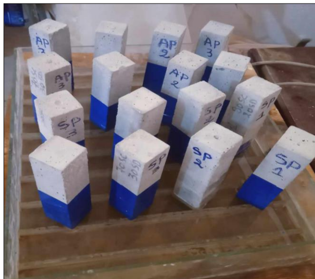
Figure II.17. Essai de l'absorption capillaire (sorptivité).
