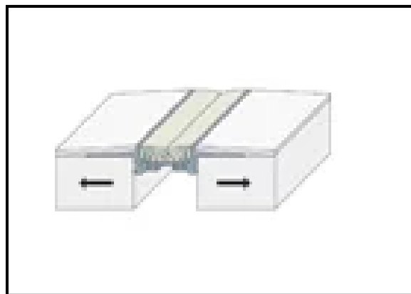
Figure 18:couvre joint de dilatation Source : PDF profilés pour joints dilatation et mouvement.
