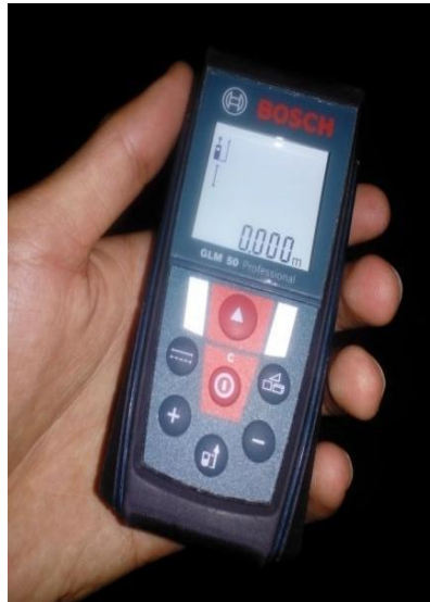
Figure 106 : mètre laser Source : auteur
