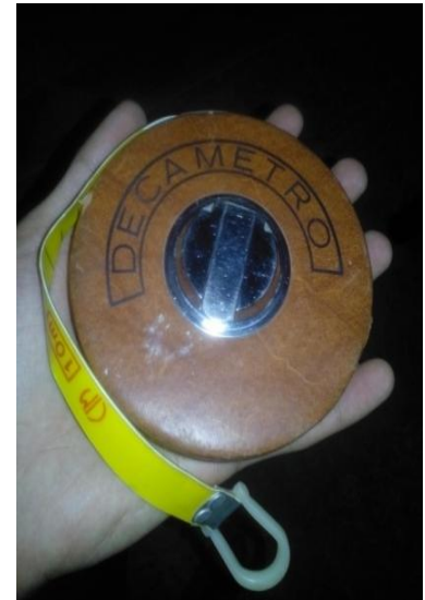
Figure 107 : décamètre Source : auteur
