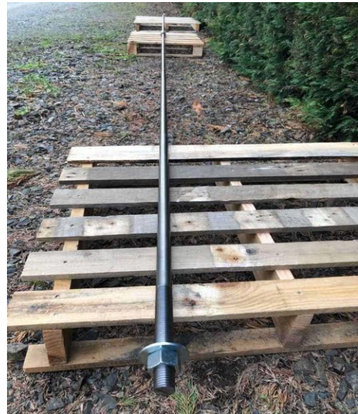
Figure 45 : tirant métallique Source : cledetirant.e-monsite.co
