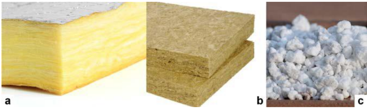
Figure VI.11. Isolants minéraux : (a) Laine de verre, (b) Laine de roche et (c) Perlite.
