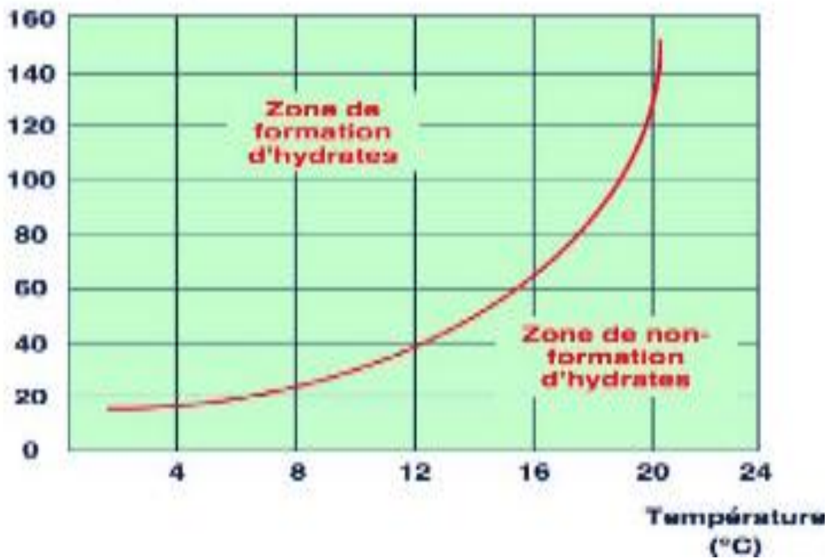
Figure II.2 : Courbe de formation d'hydrates
