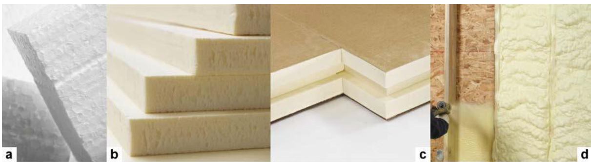
Figure VI.12. Isolants synthétiques : (a) Polystyrène expansé (PSE), (b) Polystyrène extrudé (XPS), (c) Plaques de polyuréthane et (d) Polyuréthane projeté.
