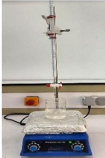
Figure 17 : Montage de titrage pour la détermination du degré d'estérification.
