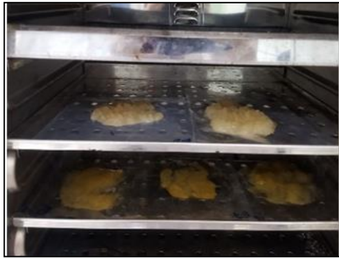
Figure 15 : Séchage de la pectine dans l'étuve.
