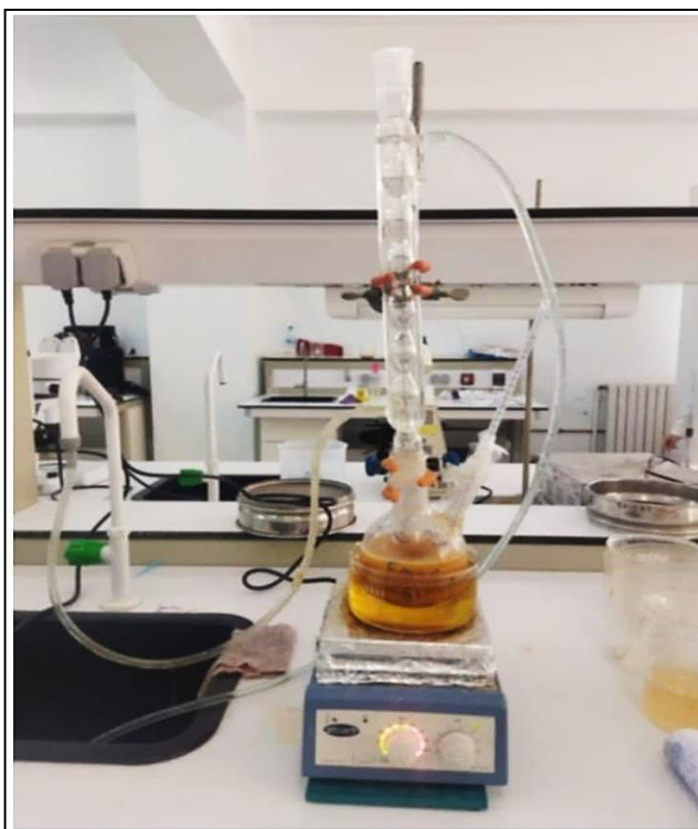
Figure 11 : Montage à reflux utilisé pour l'extraction de la pectine.
