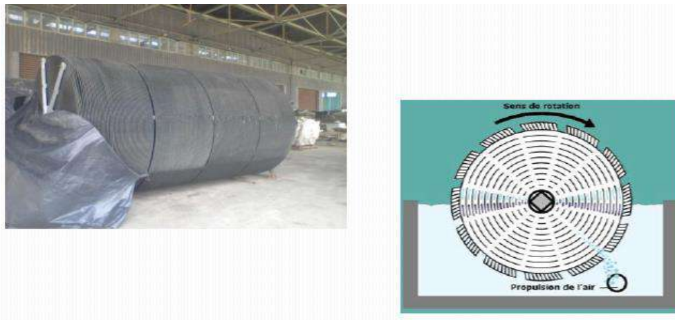
Figure II.3.5 : L'épuration biologique par disques biologiques rotatifs
