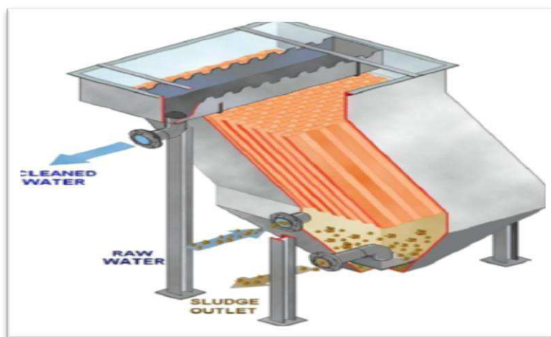
Figure I.3.36 : décantation à contre-courant
