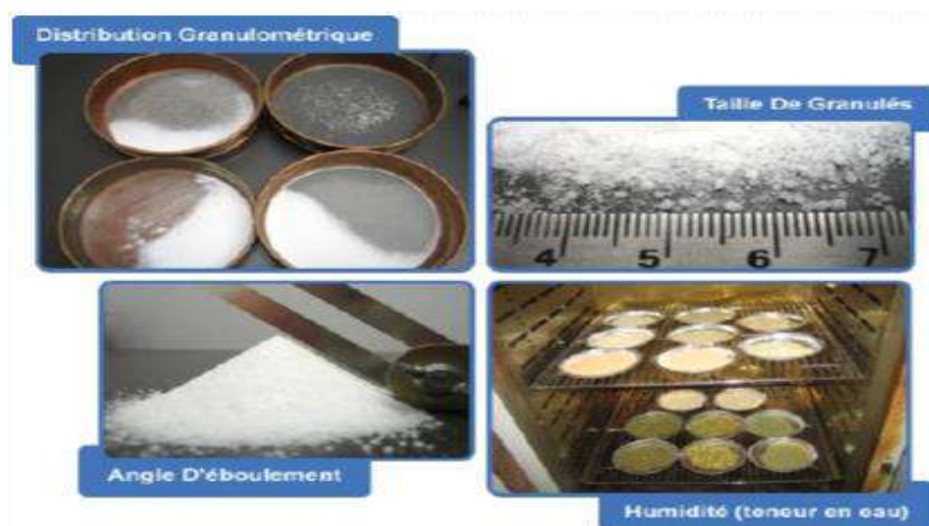
Figure I.3.44 : les caractéristiques granulométriques du matériau filtrant
