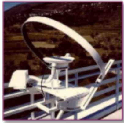
Figure 1.10 – Pyranomètre équipé d'un pare-soleil.
