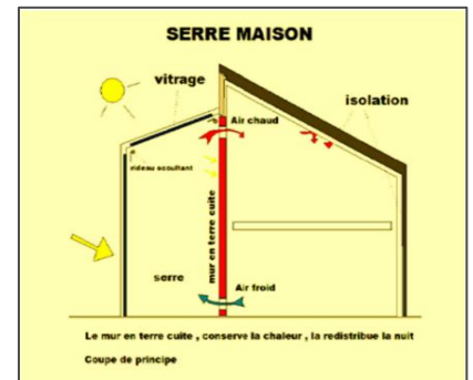
Figure 24 : Schéma de serre bioclimatique. Source : ouvrage traité d'architecture et d'urbanisme
