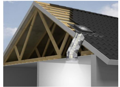
Figure 41 : Conduite de lumière Naturelle. Source : www.archidaily.com
