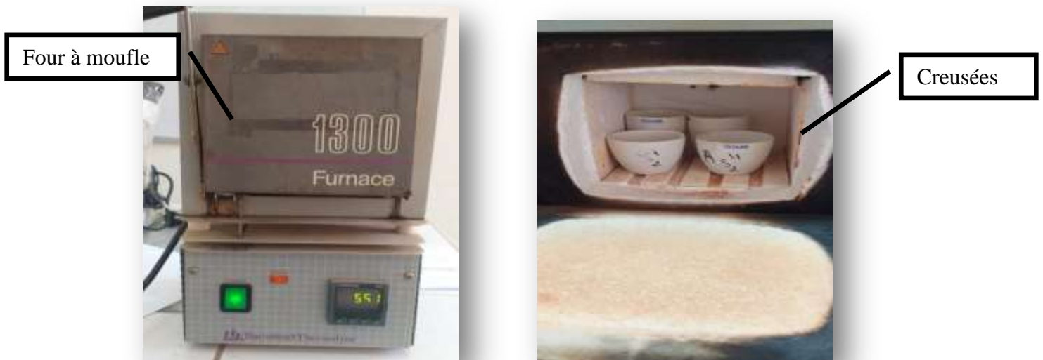
Figure 9 : Four à moufle à 550 °C (original 2021)
