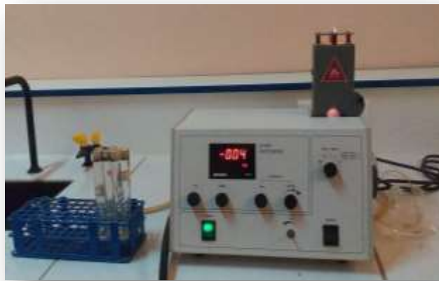
Figure 11: Spectrophotomètre à flamme pour la lecture du Sodium et du Potassium originale(2021)
