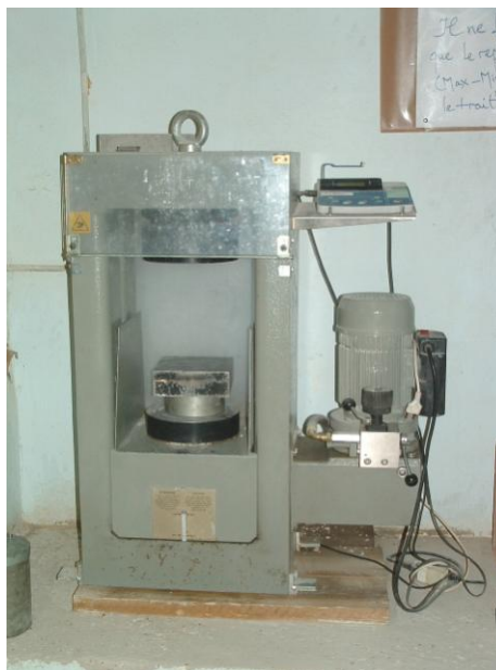
Photo 3 : La presse utilisée pour la compression.
