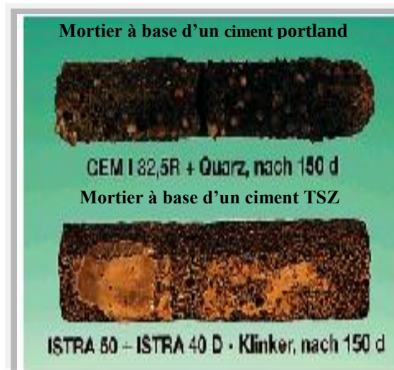
Fig. I.29. Epruvettes prismatiques à base de ciment alumineux et de CPA après attaque de 150 jours à l'acide sulfurique.
