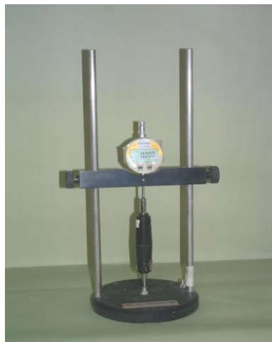
Photo 6 : Appareil utilisé pour mesurer le retrait de séchage.
