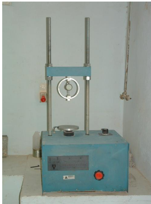
Photo 4: La presse utilisée pour la flexion.
