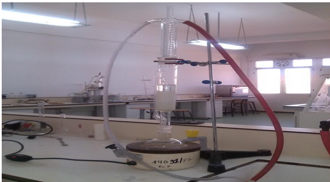
Figure 18 :Montage d'extraction à chaud (solide –liquide) des lipides
