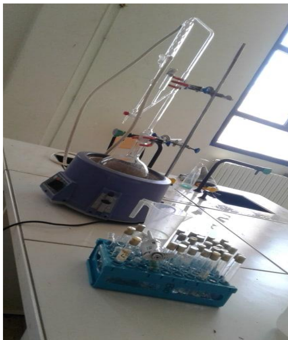
Figure 22 : Montage d'hydrodistillation (Clevenger).
