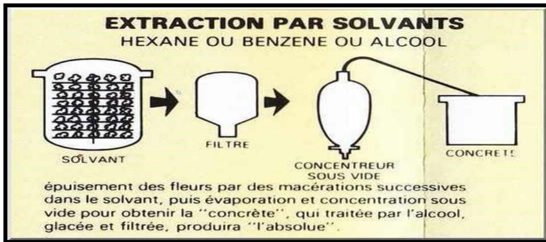
Figure 06 : Technique d'extraction par solvants.
