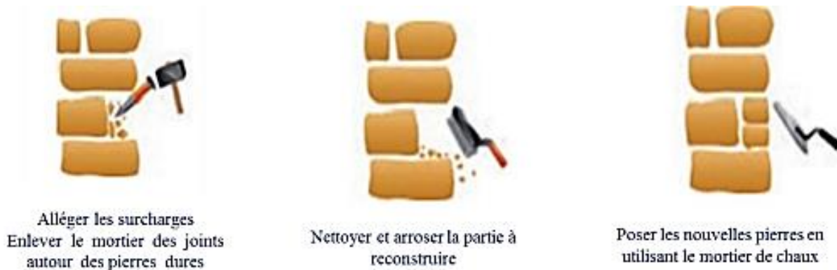
Figure 128: schéma des étapes de la réparation de la pierre [37].
