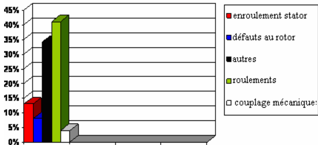
Figure I.09: Répartition des pannes des machines de fortes puissances [8].
