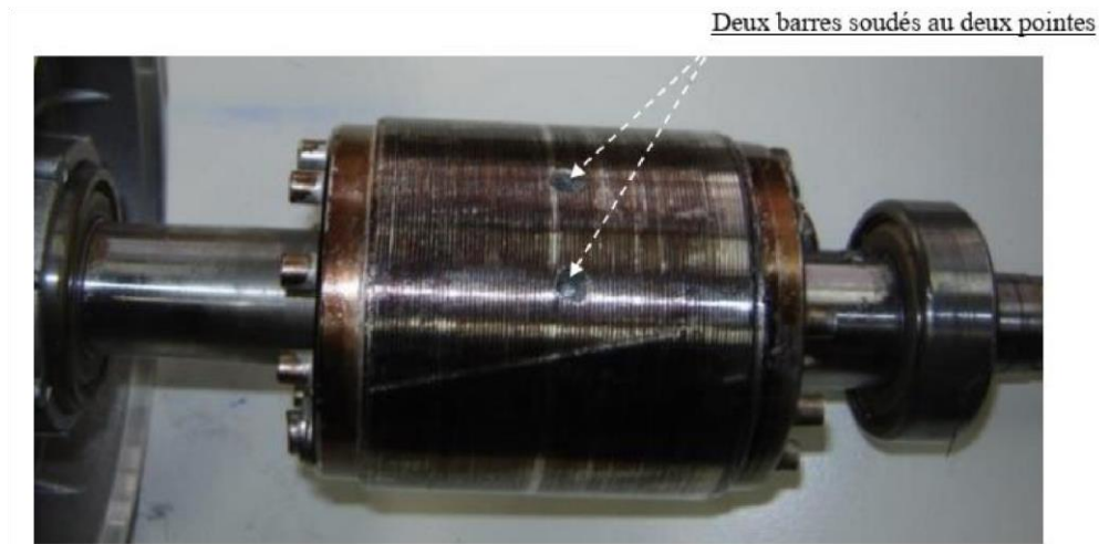
Figure 1.12 : Défaut deux barres cassées
