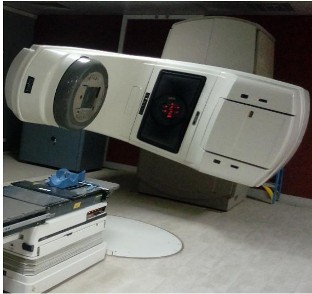
Figure 2.3 : Accélérateur linéaire du service CAC de BATNA, Modèle Varian.
