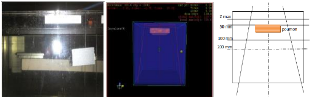
Figure 4.11 : OTN équivalent poumon, taille de champ 25x25 cm 2 , SSD=100 cm, Densité du poumon=0.21g/cm 3
