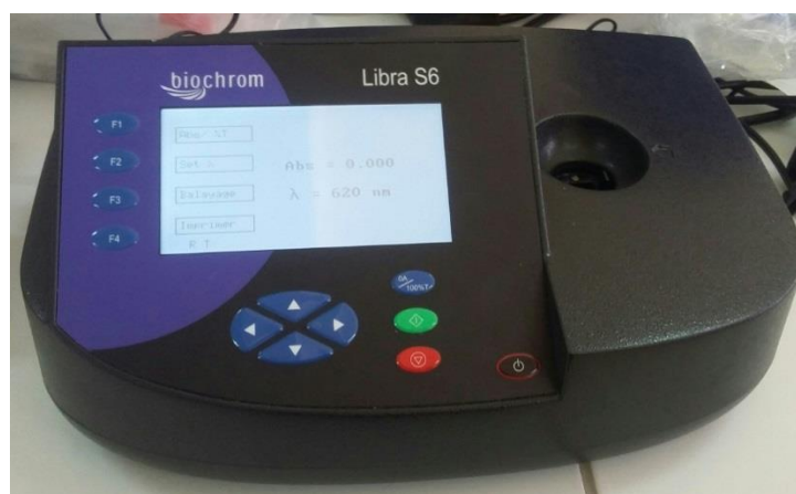
Figure 9: spectrophotomètre UV-visible utilisé dans le contrôle
