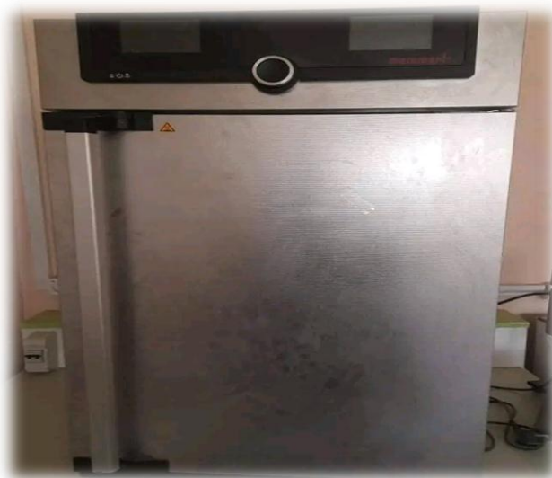
Figure II.5. Photo de l'étuve de séchage utilisée au laboratoire.
