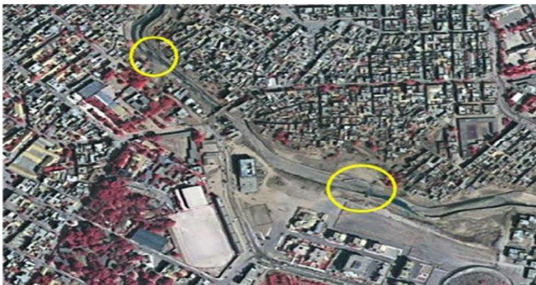
Figure 34:Impacts de l'inondation identifiés sur les images du satellite Kompsat (© KARI), matérialisés par la destruction de deux passerelles (cercle en jaune).
