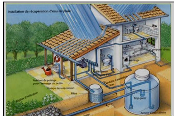
Fig. VI 36 Principe de la gestion d'eau. Source : www.Aquabion.com
