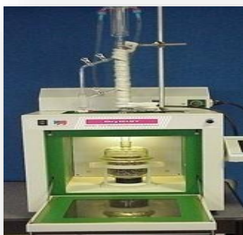
Figure5: Schéma de l'appareil d'extraction par micro-onde sous vide(Hemwimon et al. , 2007).
