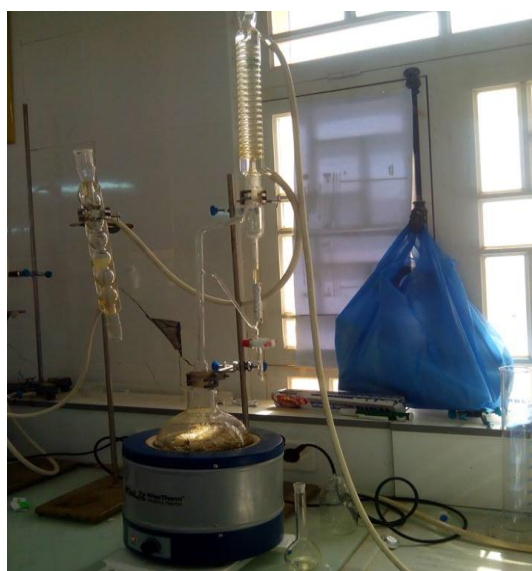
Figure 14 : Photo représente le dispositif d'hydrodistillation (Clevenger) utilisé pour l'extraction de l'huile essentielle. (Bouzekri et Ben Khamassi.,2017).
