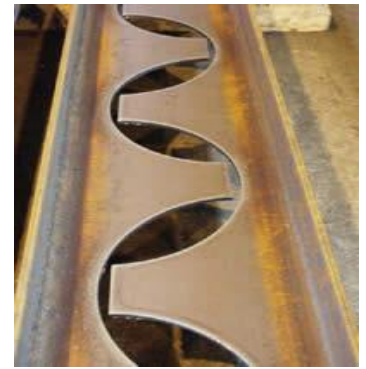
Figure 30: poutres alvéolaires. Source : Google images.
